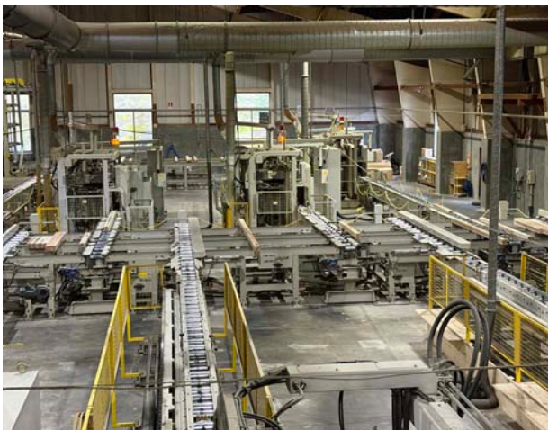
木口+スリット加工3ラインへ分岐するコンベア（左）と木口+スリット加工機（右）
