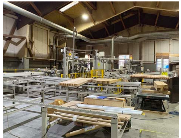
束加工機（左）と柱材加工機（右）は並んで配置されている
