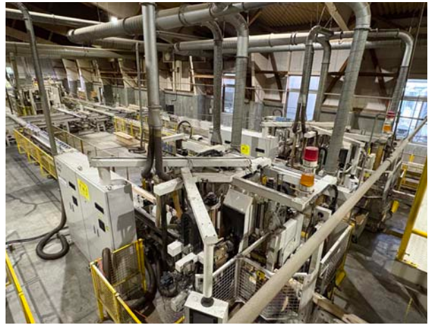
上下側面加工4ラインへ分岐するコンベア（左）と4台の上下側面加工機（右）
