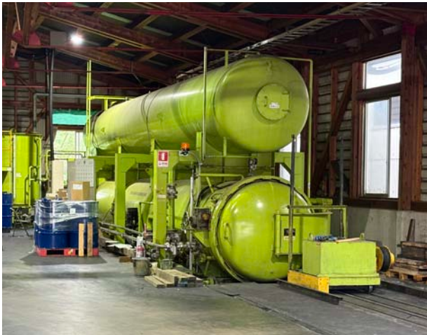
注入棟の湿式注入設備（左）と乾式注入設備（右）
