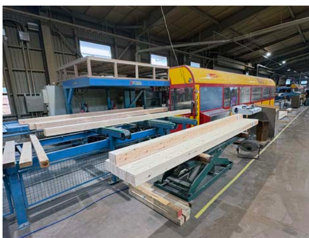
加工ユニットを最大限に配置した「K2i MAX」
