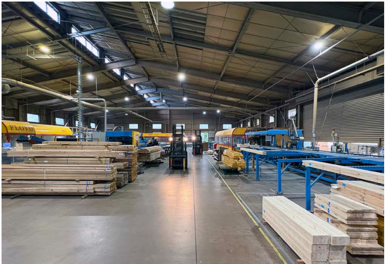
第1工場棟にはフンデガーの特殊加工機が5台設置され休みなく稼動している
