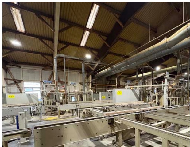
木口+スリット加工3ラインへ分岐するコンベア（左）と木口+スリット加工機（右）
