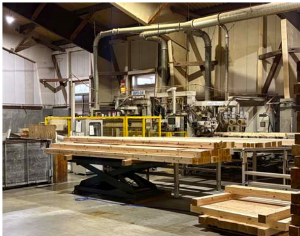
束加工機（左）と柱材加工機（右）は並んで配置されている
