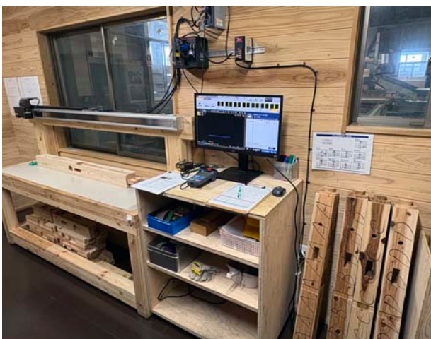
毎朝、3次元測定器を使用して試験片の精度測定を行う
