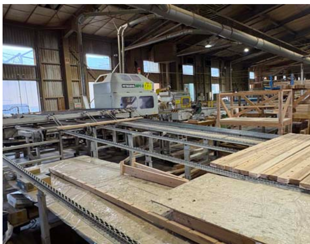
第2工場棟には2台の羽柄材加工機（左）と2台の合板加工機（右）
