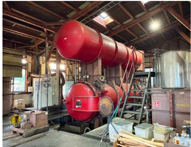
注入棟の湿式注入設備（左）と乾式注入設備（右）
