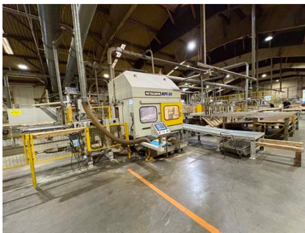
ライン加工・単体加工の双方が可能な多種加工機
