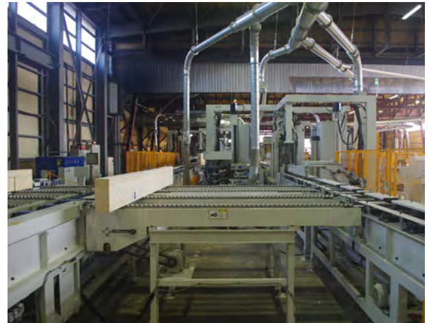
材料を効率良く流すためのバイパスが設けられた横架材加工ライン
