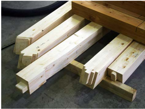
XF15で入力された登り梁や斜め仕口など特殊加工のサンプル
