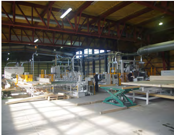
材料を効率良く流すためのバイパスが設けられた横架材加工ライン
