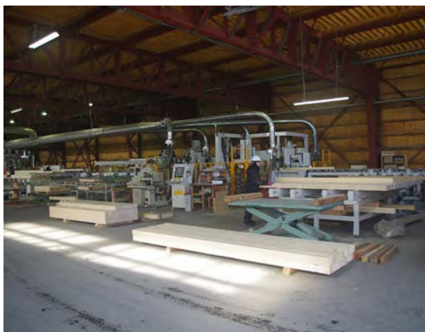
横架材加工ラインと同様、金物工法にも対応した柱材加工ライン
