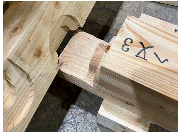
XF15で入力された登り梁や斜め仕口など特殊加工のサンプル
