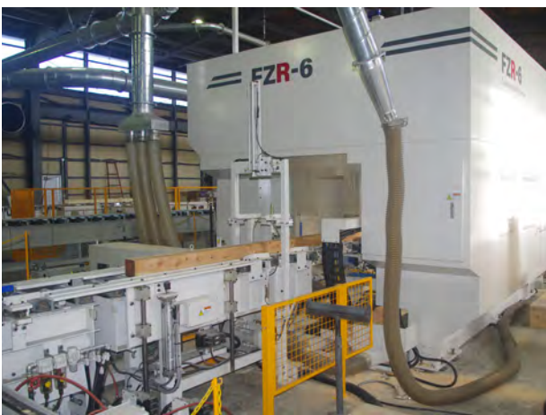
5軸加工機は単体加工/ライン加工が可能となっている
