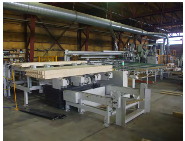
横架材加工ラインと同様、金物工法にも対応した柱材加工ライン
