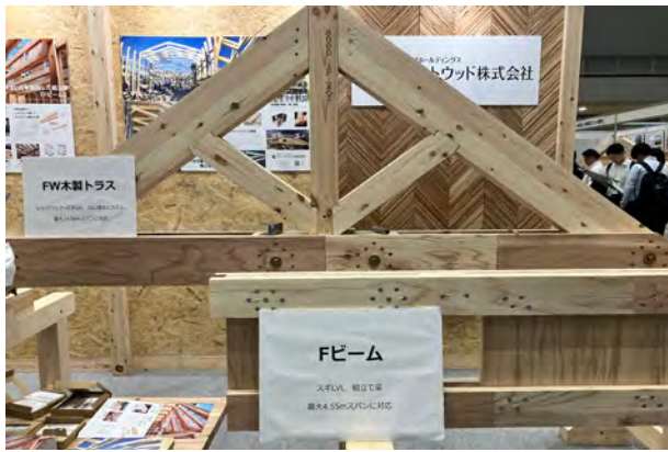
スギ LVL を使用した組立梁「Fビーム」
