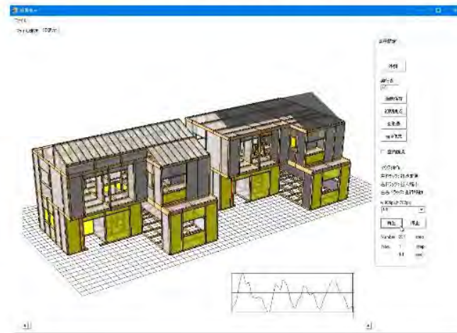
木造住宅 (金物工法) タツミテックワンP3
