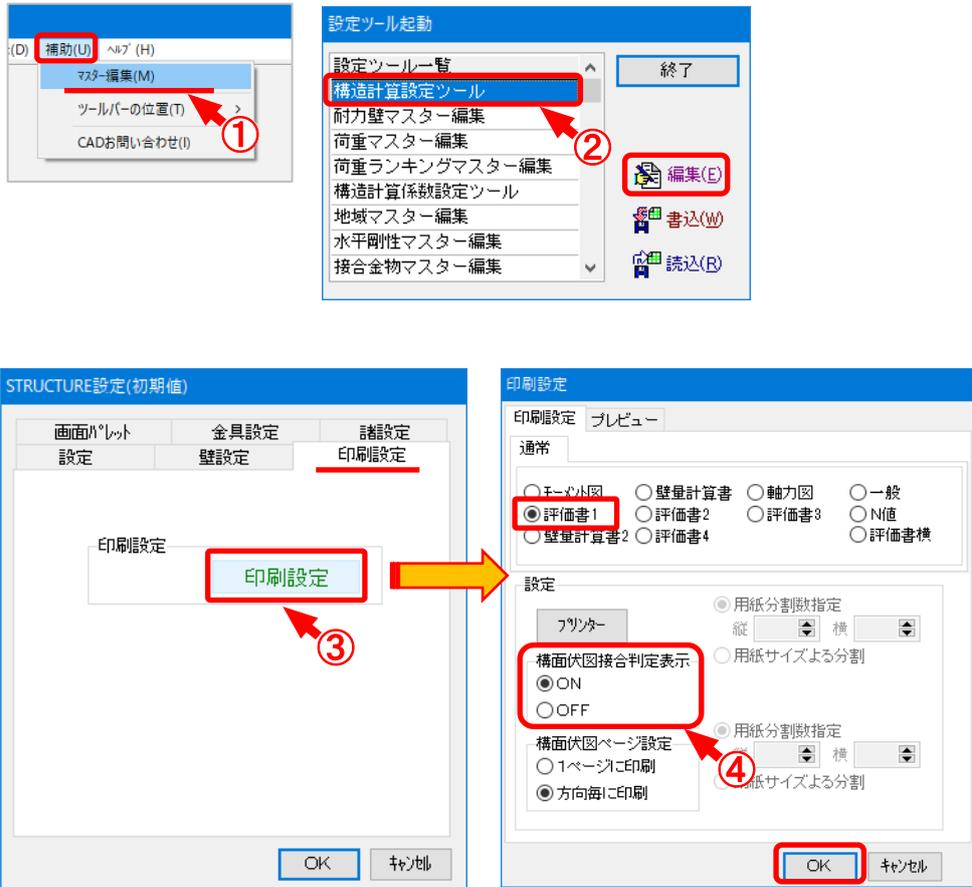
水平構面伏図に表示される「J 1」「J 2」や「T 1」「T 2」の接合判定結果の記号表示ON/OFFをマスターで設定できます。
